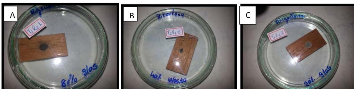
Figura 02. A – *R.solani* em corpos de prova a 80% de umidade; B – *R.solani* em corpos de prova a 40% de umidade e C – *R. solani* em corpos de prova a 20% de umidade.
